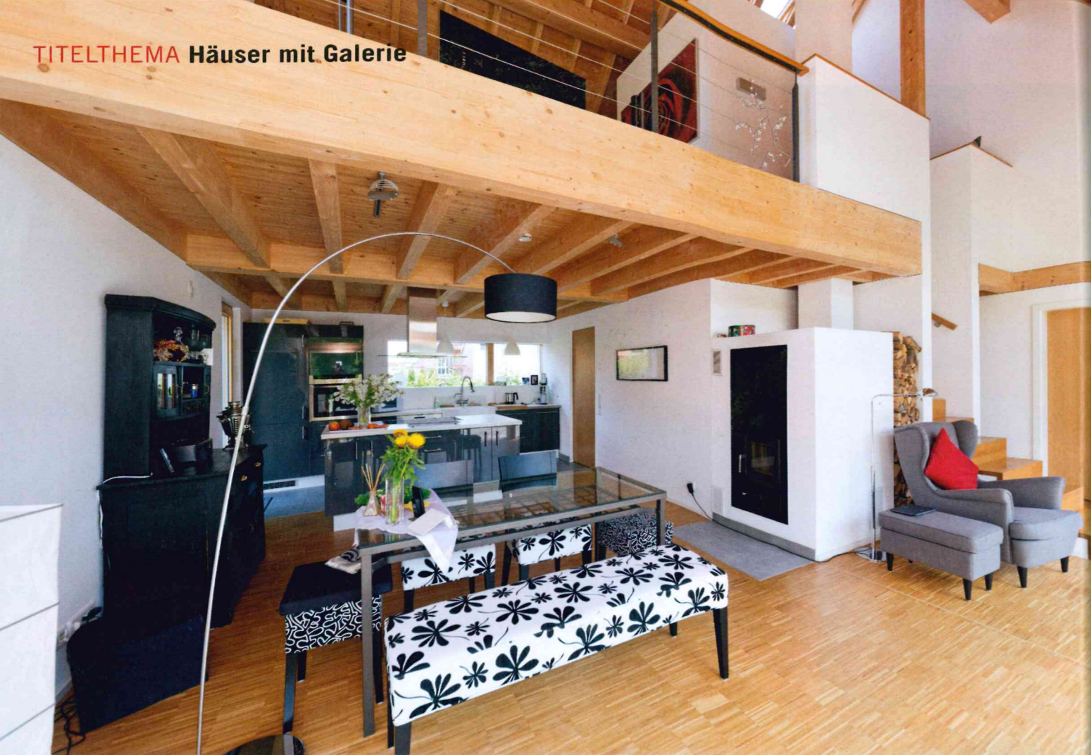
Unter der Galerie liegen Küche und Esstisch, hinter dem Holzofen ist der 8000 Liter fassende Solarspeicher für die Heizung integriert, der vom Keller bis ins Dachgeschoss reicht und nur in langen, sonnenarmen Kälteperioden per Holzheizung unterstützt werden muss.
